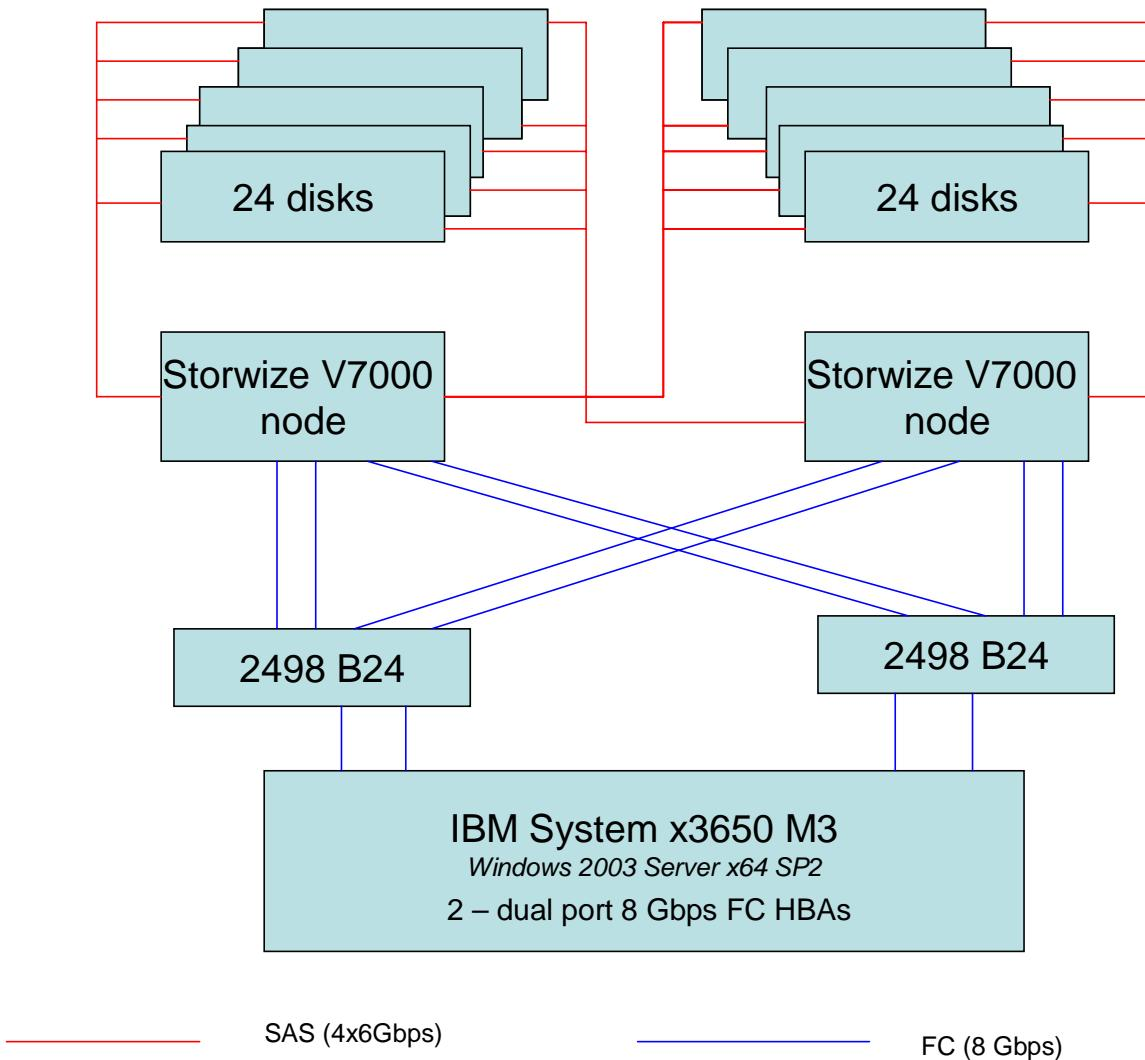
**2498 B24:** 24-port fibre channel switch
