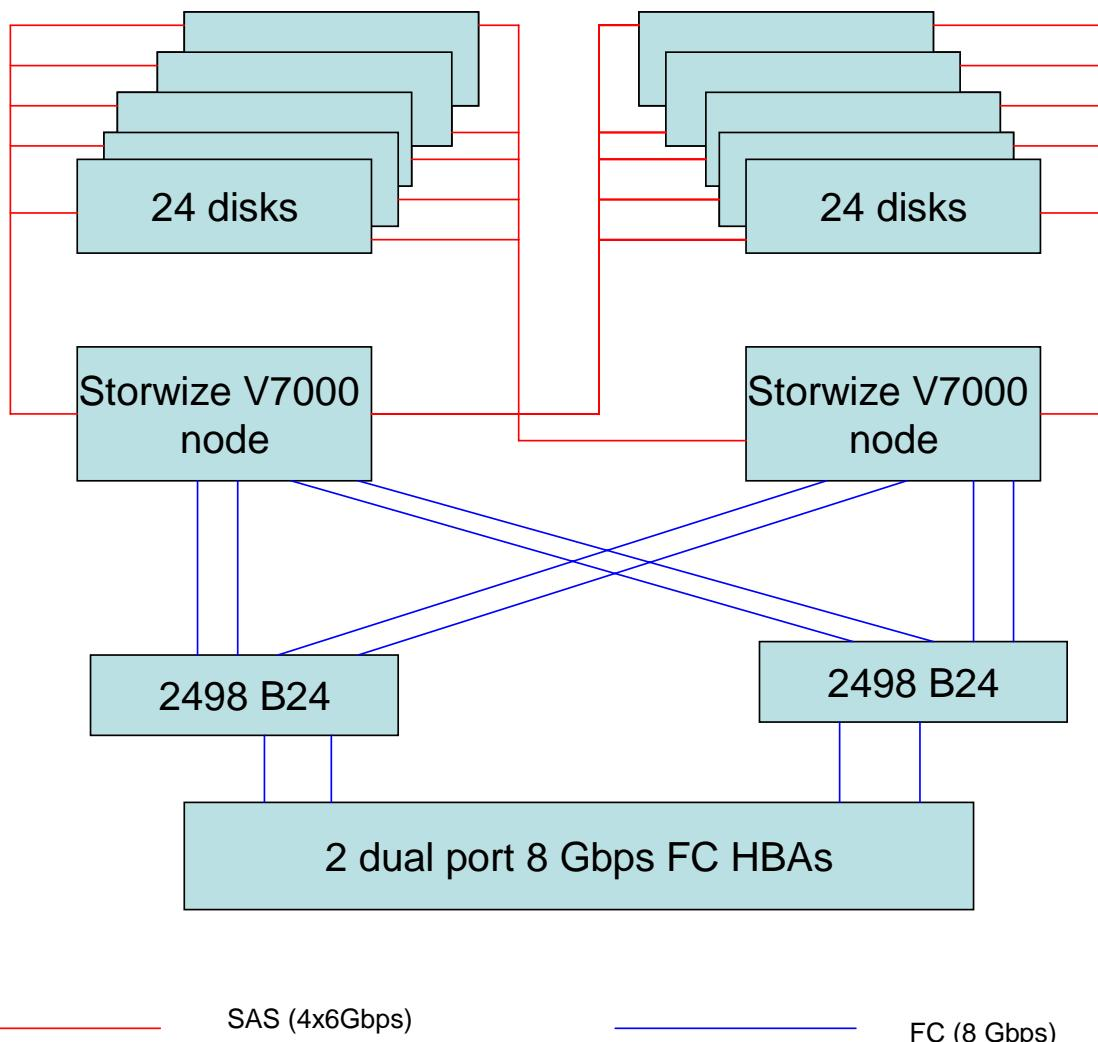
**2498 B24:** 24-port fibre channel switch
